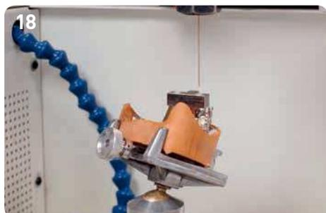
Per l'esatta guida forzata l'elettrodo (codice di ordinazione 30-1004) è stato inserito nella bussola in teflon della guida dell'elettrodo. Bussola adatta a un elettrodo di 0,8 mm.
