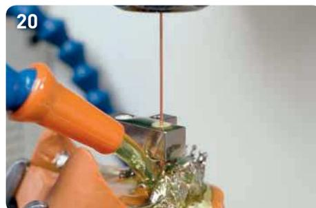
Dopo che è partita l'alimentazione del liquido dielettrico, inizia il processo di erosione - vedi parametri delle schede tecniche.
