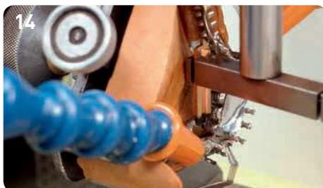
13 L'alimentazione del liquido dielettrico è partita, il serbatoio viene riempito, inizia il processo di elettroerosione. Per i parametri di erosione vedi lista dei parametri: EDM 2000.
