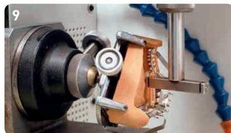
7 Controllo visivo della posizione degli elettrodi. L'elettrodo deve colpire il perno, in modo che il naso del chiavistello entri completamente nell'accoppiamento eroso del calcinabile conico.
