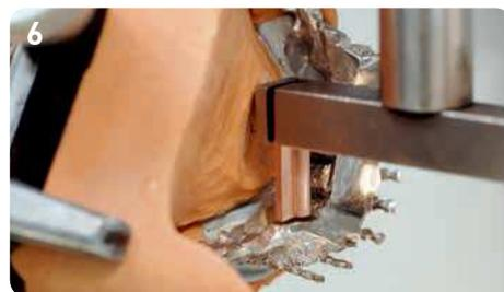
5 Posizionamento del modello con elemento primario e secondario con un angolo di 90° rispetto al piano della bocca. Regolazione della posizione di erosione mediante elettrodo diritto tagliato a misura. Impostare sul display i punti zero per gli assi X e Y.
