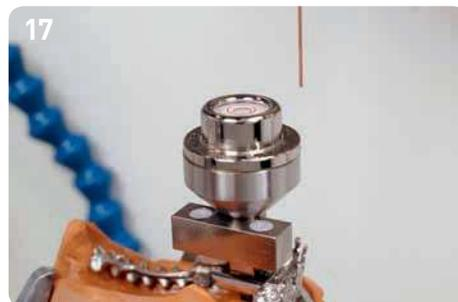
Per l'erosione dell'asse del chiavistello con un angolo di 90° (codice di ordinazione 30-1242) l'elemento chiavistello viene inserito nell'accoppiamento del chiavistello al quale si monta la guida dell'asse (codice di ordinazione 30-1602). La livella inserita nell'alloggiamento del chiavistello (codice di ordinazione 82-1201) serve per regolare il parallelismo.
